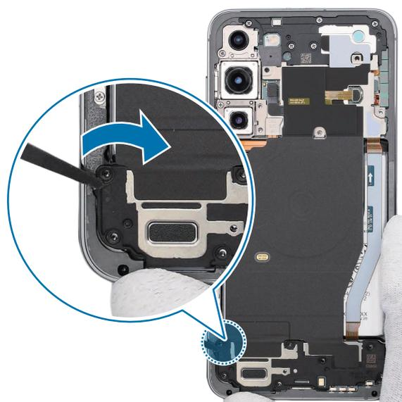
4 Use las pinzas para levantar la parte derecha de la placa metálica con cuidado y extráigalo del dispositivo.
