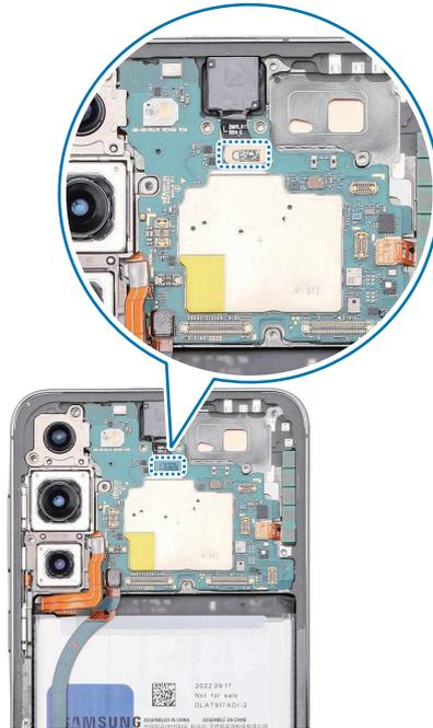
4 En el caso de los dispositivos 5G de los Estados Unidos, use las pinzas y los dedos para conectar los dos conectores adicionales de la antena 5G mmWave de la placa principal.
