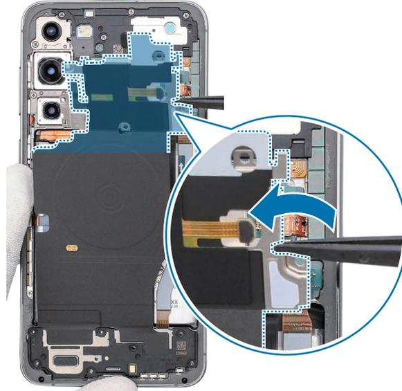
5 Separe el módulo de carga inalámbrica y el módulo del altavoz del dispositivo a la vez.
