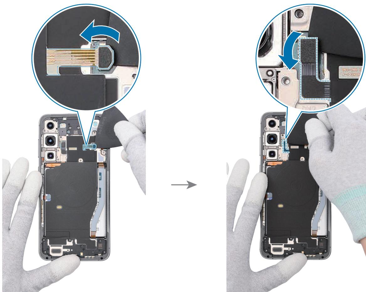
3 Coloque las pinzas en la esquina izquierda del módulo de altavoz. Para ello, incline el módulo de altavoz de forma que esté inclinado más de 90°.
