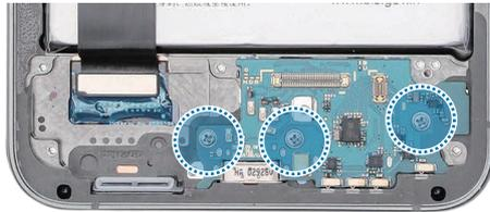
5 Use las pinzas o el palito de desmontaje para levantar la muesca de separación situada en la parte superior derecha del módulo del puerto de carga y retírelo.
