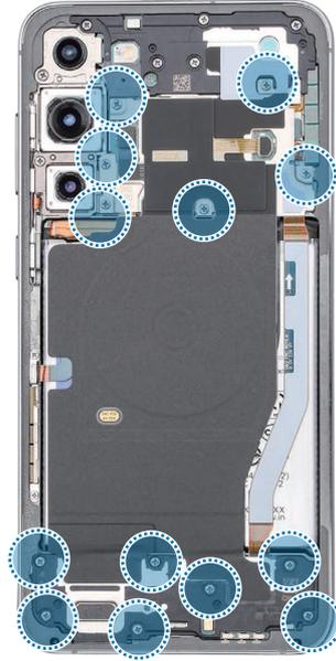
2 Separe los dos conectores del módulo NFC y del módulo UWB con la púa de apertura.
