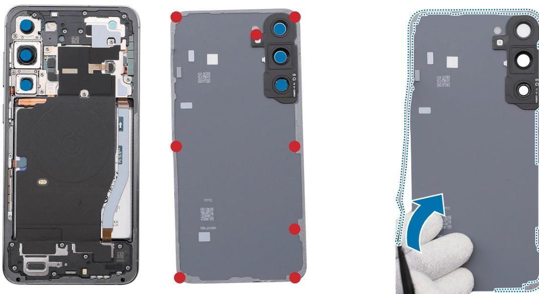
15 Con los dedos o las pinzas, retire la cinta adhesiva de doble cara situada alrededor del orificio del micrófono.
