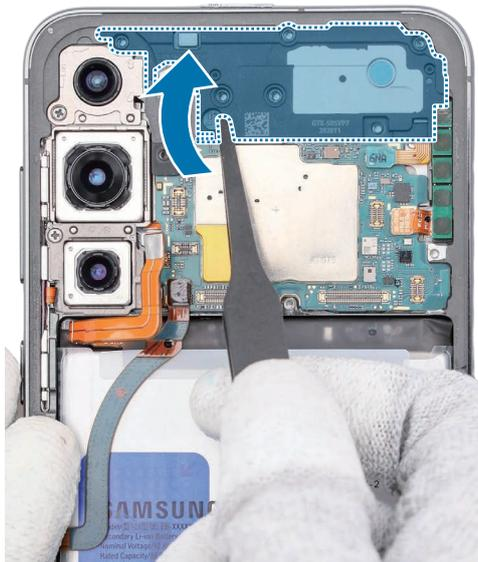
5 Compruebe los tornillos en los dos puntos distintos en el chasis de la cámara y retírelos con un destornillador de estrella.
