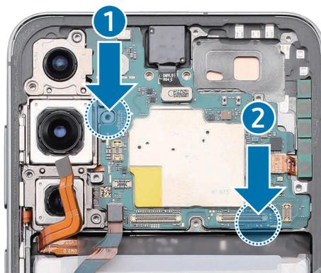
3 Use las pinzas y los dedos para conectar el conector de la cámara frontal en la placa principal.
