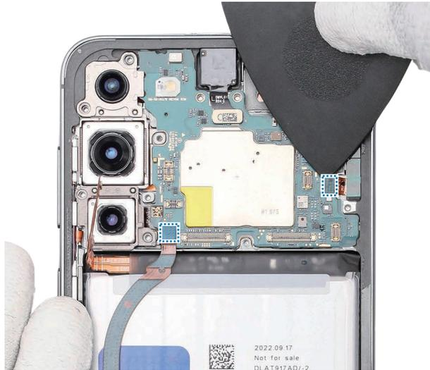
8 Con las pinzas, levante la muesca de separación situada en la parte superior derecha de la placa principal y retire el módulo de la placa principal.
