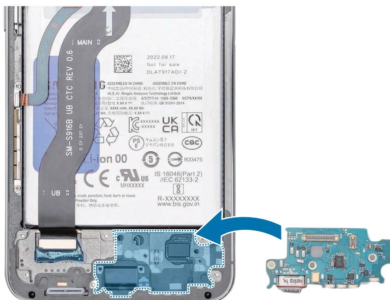
2 Compruebe el tornillo 3428 (3 unidades) en los tres puntos distintos del puerto de carga y fíjelos.
