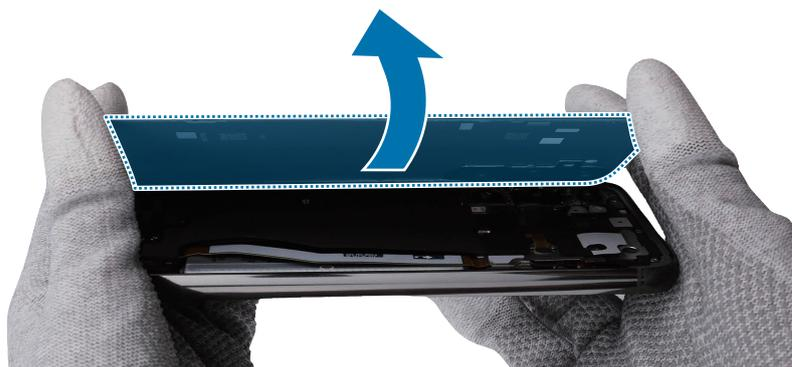
14 Retire todas las cintas adhesivas de la tapa posterior y la parte posterior del dispositivo (●) una a una.
