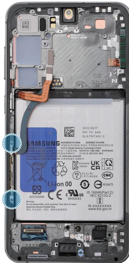
2 Inserte el extremo en punta de las pinzas en el hueco que hay entre el soporte del tornillo inferior del soporte de la antena 5G mmWave izquierda y el chasis.
