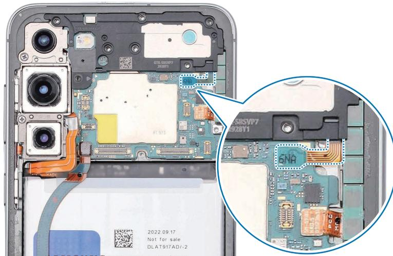
8 Inserte y atornille el tornillo 3428 (5 unidades) en sus orificios correspondientes.
