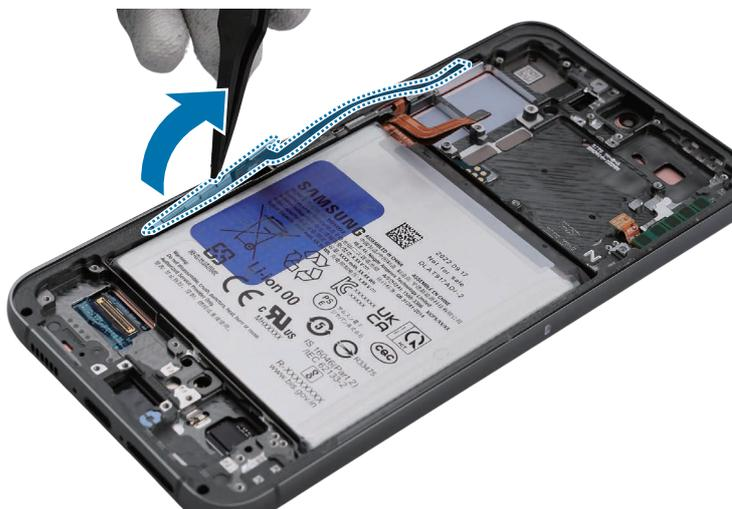
3 Retire la parte inferior del módulo de la antena 5G mmWave.
