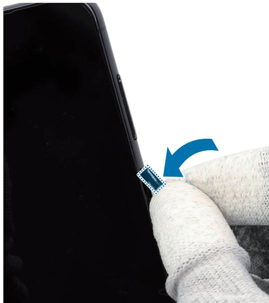
6 Presione el botón Función con cuidado y de manera uniforme para que pueda ensamblarse completamente.
