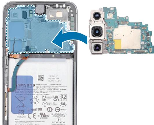
2 Coloque la parte superior del módulo de la placa principal en diagonal sobre el módulo de pantalla, monte la parte inferior y, a continuación, presiónela hacia abajo para encajarla en su sitio.
