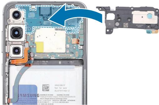
7 Use las pinzas o los dedos para conectar el conector del cable del FRC superior en la placa principal.
