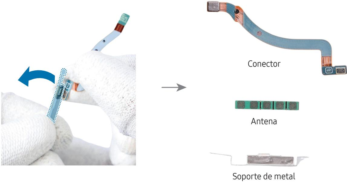
5 Introduzca el extremo en punta de las pinzas en el hueco que hay entre el borde de la antena 5G mmWave derecha y el chasis.
