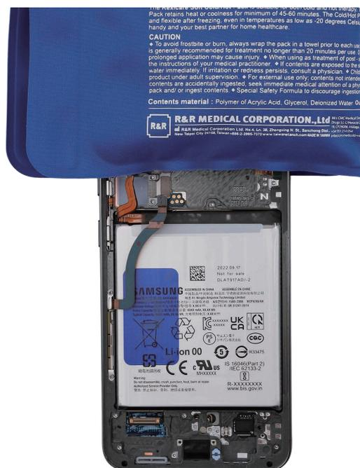
2 Antes de que se enfríe el calor aplicado con la bolsa térmica, retire el adhesivo de unión entre la cámara frontal y el módulo de pantalla con la ayuda de la anilla de extracción de la bandeja de la SIM.
