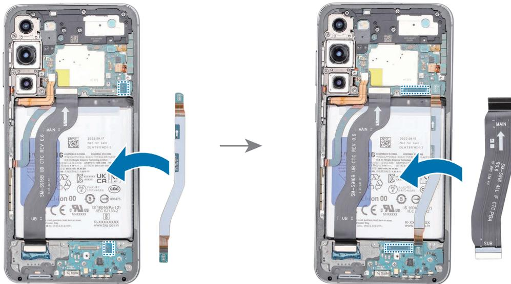
4 Compruebe cuidadosamente con los dedos si hay tornillos u otros elementos extraños dentro del dispositivo (batería, PBA, cable, etc.).
