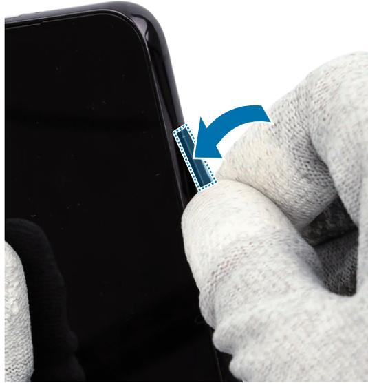
3 Presione el botón Volumen con cuidado y de manera uniforme para que pueda ensamblarse completamente.
