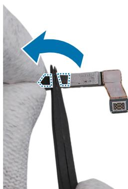
2 Retire la película transparente del nuevo adhesivo y colóquelo en la parte inferior de la antena de modo que el extremo redondo se encuentre en la posición más alejada del conector.
