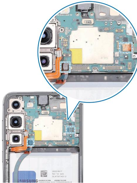
5 Compruebe los tornillos 3428 (2 unidades) en los dos puntos distintos del chasis de la cámara y fíjelos con un destornillador de estrella.
