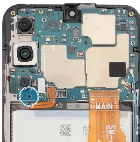
2 Use la púa de apertura para separar el conector del cable flex de la placa principal y extraiga el cable flex.
