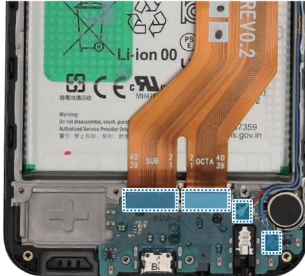
6 Compruebe el tornillo negro 1530 (1 unidad) y apriete el tornillo en el puerto de carga con un destornillador de estrella.
