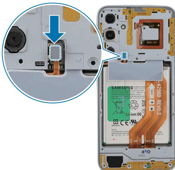
11 Compruebe los tornillos 3420 (15 unidades) en los 15 puntos distintos del soporte trasero y fíjelos.
