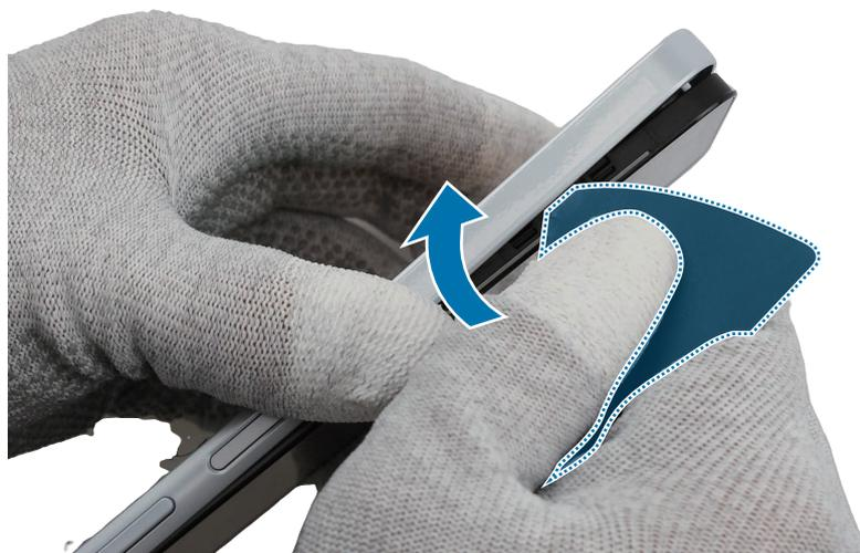
10 Introduzca la púa de apertura en la ranura que hay entre el borde superior del soporte trasero y el módulo de dispositivo, y aumente la ranura moviendo la púa de apertura en el borde superior.
