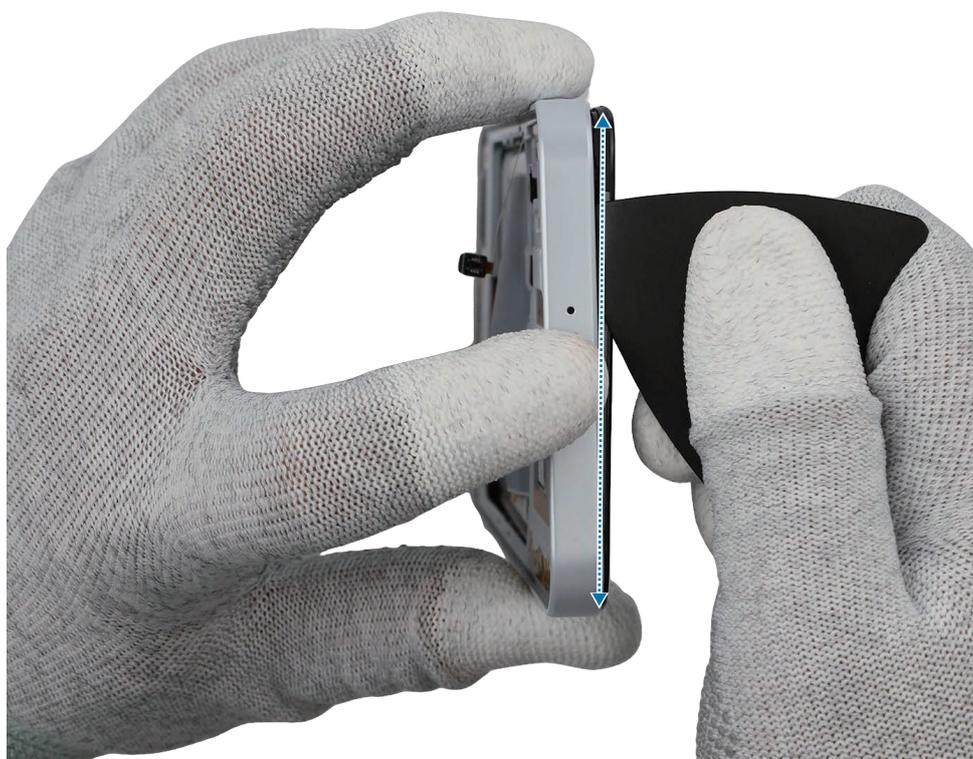
11 Deslice la púa de apertura a lo largo del borde superior y separe el borde superior del soporte trasero del módulo de dispositivo con cuidado.
