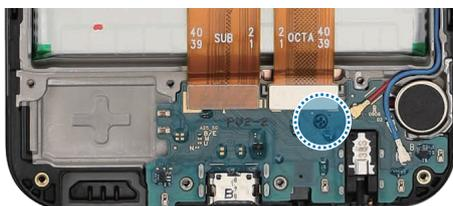
15 Separe los dos conectores del cable flex del puerto de carga con la púa de apertura.
