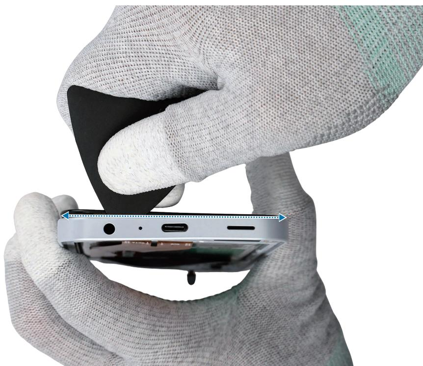
7 Deslice la púa de apertura a lo largo del borde inferior y separe el borde inferior del soporte trasero del módulo de dispositivo con cuidado.
