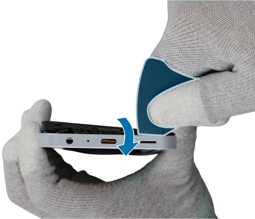
8 Introduzca la púa de apertura en la rendija que hay entre el borde derecho del soporte trasero y el módulo de dispositivo, y aumente la rendija moviendo la púa de apertura en el borde derecho.
