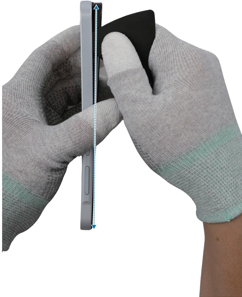
9 Deslice la púa de apertura a lo largo del borde derecho y separe el borde derecho del soporte trasero del módulo de dispositivo con cuidado.
